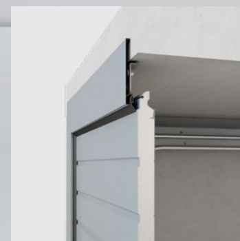
Montering i åbningen – facadepanel foran åbningen
